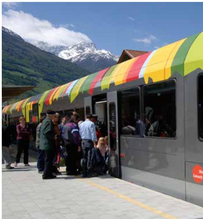
Die heutigen mit Diesel betriebenen Garnituren werden durch längere, elektrisch betriebene Flirt-Züge ersetzt.
